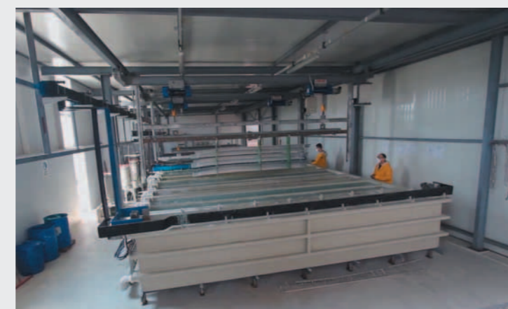
Процесс покрытия проводников оловом
